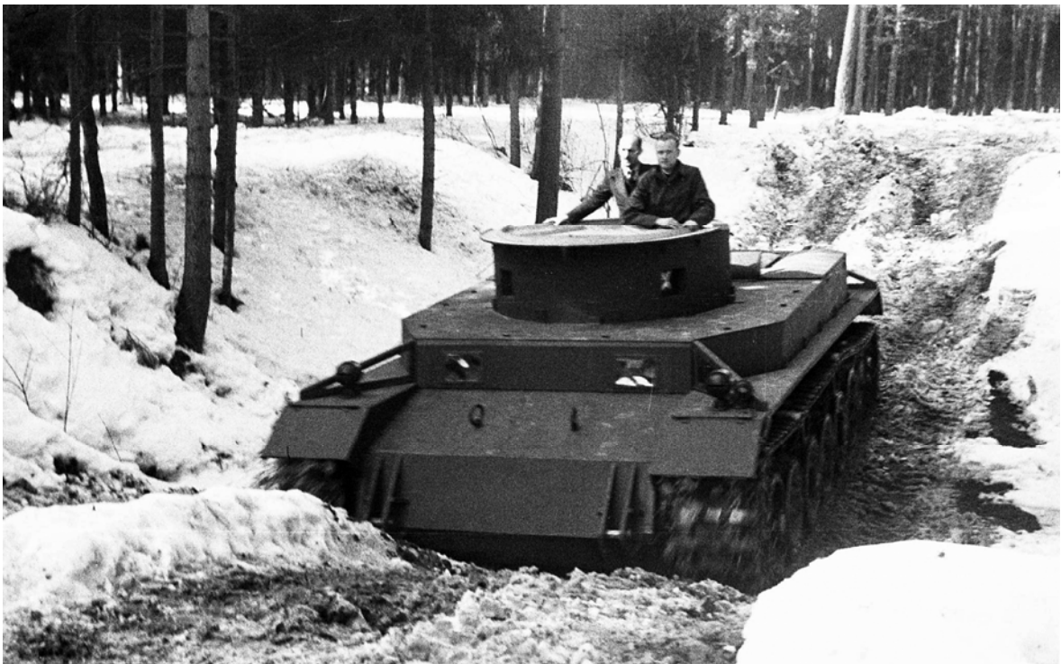
Einer der beiden VK3001 (P) bei Testfahrten auf der Einfahrbahn im Winter 1941/42. Die Fahrzeuge erhielten keine Drehtürme. Für die Fahrwerkserprobung war anstelle des Turms ein gleich schweres Gewicht aufgesetzt. [Archiv ECS]
