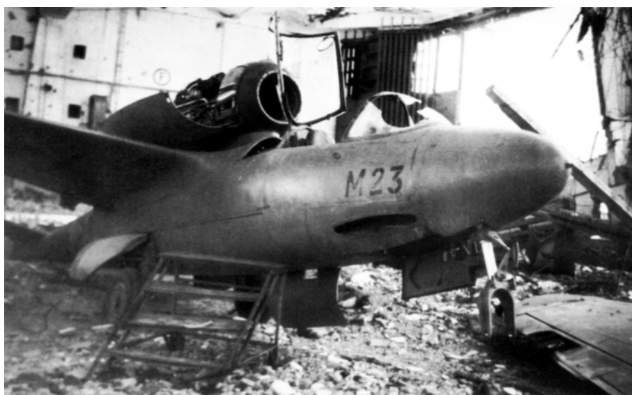
Die Werknummer 220006 (M-23) wurde am 1.Mai 1945 in München-Riem erbeutet. Die Maschine kippte ohne Waffen und Bugrad nach hinten.
